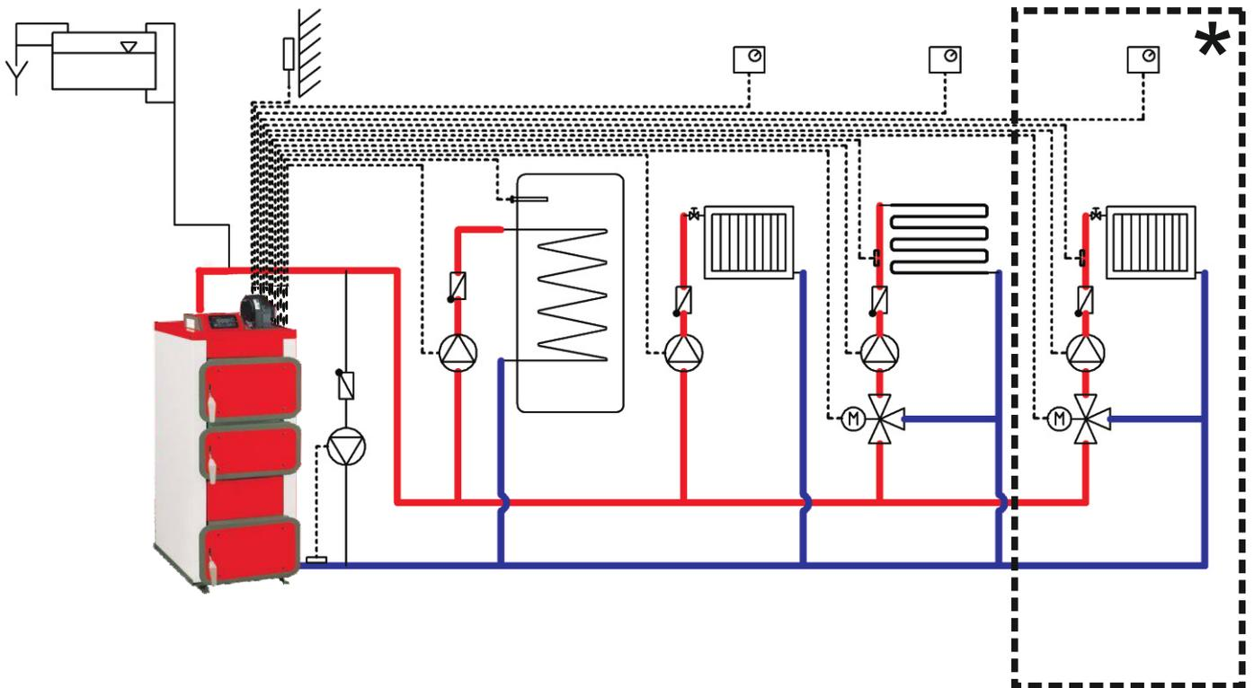
\* Независимое управление смесительным клапаном с использованием контроллера HT tronic Z3D (опция для котла Q HIT Plus Comfort)
