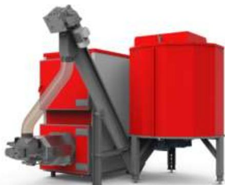
Автоматический комплект для сжигания биомассы MAXPELL ZB. Конструкция основана на теплообменнике котлов серии MAXPELL. Части горелки, подверженные воздействию высоких температур во время сгорания, изготовлены из высококачественной жаростойкой стали. Емкость топливного бака 1м<sup>3</sup>, оснащен системой перемешивания топлива.
