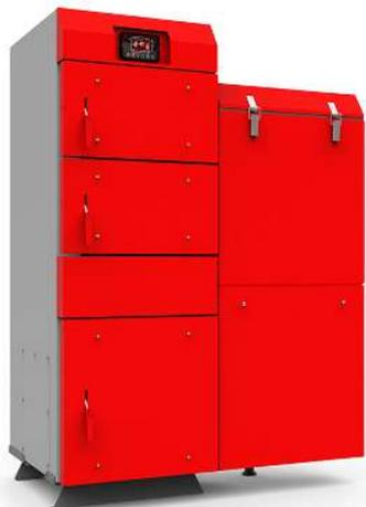
**HT EKO GL** - это автоматический котел, конструкция которого основана на теплообменнике **Heiztechnik** с высокой эффективностью теплообмена. Котел оснащен чугунной ретортной горелкой со встроенным винтовым питателем, предназначен для отопления углем фракции 8 – 25 мм в автоматическом режиме. Котел характеризуется высокой эффективностью и простотой в эксплуатации.
